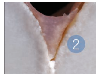
2 Отслаивание от краёв.
